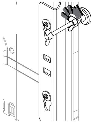
18. Ziehen Sie die Flügelmuttern auf der Rückseite der Montagehalterungen fest, bis die Flügelschraube fest sitzt. Halten Sie die Flügelschraube fest, wenn sie sich beim Anziehen der Flügelmutter mitdreht.
