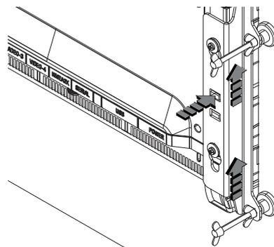
Die Halterungen werden in umgekehrter Reihenfolge zur Montage gelöst. Drücken Sie zum Lösen der Halterungen die Verriegelungen nach unten, und schieben Sie dann die Halterungen nach oben.
