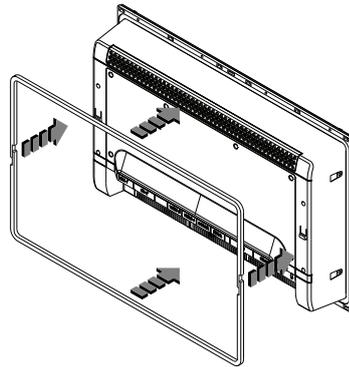
Drücken Sie die zwei Längen Schaumstoffdichtung in die Falznut auf der Rückseite des Montageflanschs des Displays. Nehmen Sie das Trägerpapier stückweise nur auf der Seite ab, die Sie auf den Monitor kleben. Stellen Sie sicher, dass die Enden beider Hälften sich überlappen und berühren.
