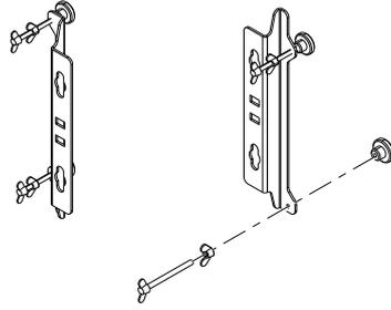
14. Montieren Sie die Halterungen auf der Rückseite des Displays, richten Sie dabei die ‚Schlüsselöffnungen‘ an der Halterung auf die Schrauben auf der Rückseite des Displaygehäuses aus.
