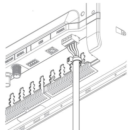
Befestigen Sie das Kabel und den Stecker, und sichern Sie anschließend die Halterung mithilfe eines Kabelbinders. Sichern Sie das Kabel so, dass kein Zug auf dieses ausgeübt wird oder dass der Stecker oder die Buchse verbogen werden.
