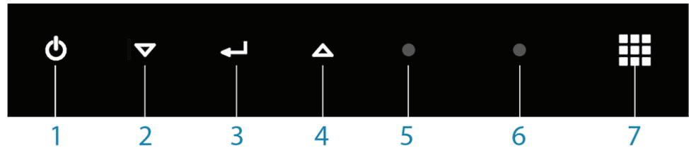
1. Ein-/Ausschalttaste: Durch langes Drücken wird der Monitor ein- bzw. ausgeschaltet. Durch kurzes Drücken wird das OSD-Menü aufgerufen bzw. zurück geblättert
