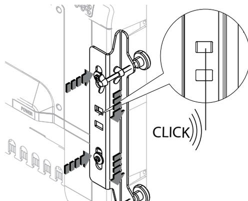
15. Wenn die Halterung und die Rückseite des Monitors sich berühren, schieben Sie die Halterung nach unten, bis sie mit einem Klick einrastet und fest sitzt.
