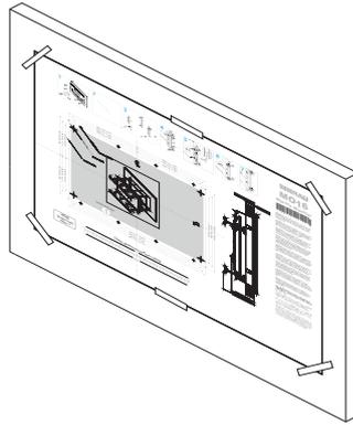
2. Befestigen Sie die Montagevorlage mit Klebestreifen auf dem Armaturenbrett, und stellen Sie sicher, dass die Schnittkonturen bezogen auf einen Referenzpunkt auf dem Armaturenbrett waagrecht sind.
