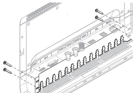
Für Kabel, die am Display befestigt werden, sollte eine Form von Zugentlastung verwendet werden. Sämtliche Displays werden mit einer Halterung geliefert, die am rückseitigen Gehäuse befestigt werden muss.
