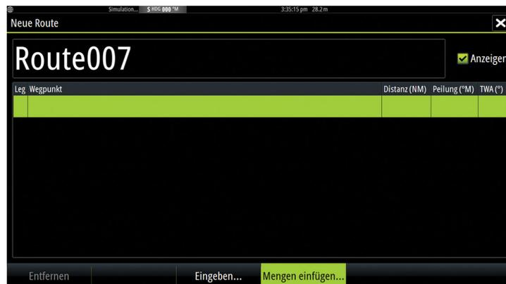
6. Geben Sie eine Liste von Wegpunkten durch Kommas getrennt ein (z. B. 21,22,23,24). Sie können Rundungsanzeigen in dem Mengeneintrag einbeziehen, indem Sie .P (Backbord) oder .S (für Steuerbord) den Wegpunkten (z. B. 21.S, 22.P, 23.S, 24.P) hinzufügen. Das System ändert die Route in einer Regattaroute, wenn Rundungsanzeigen in dem Mengeneintrag enthalten sind.
