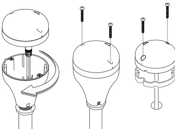
Per montare l'antenna GPS-500 esterna **su palo**, è necessario un palo di 2 cm e mezzo con filettatura da 14 TPI:
