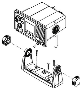
1. Appoggiare la staffa nel posto prescelto e, usando una matita morbida, tracciare la posizione dei fori da praticare nella superficie di montaggio.
