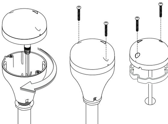
Para a **montagem em poste** da antena GPS-500 externa, será necessário um poste roscado de uma polegada tipo 14 TPI (teeth per inch):
