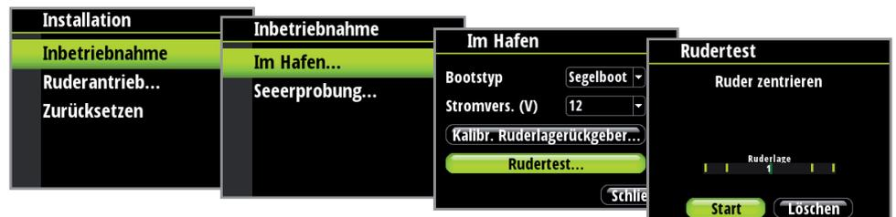
Nach einigen Sekunden gibt der Computer des Autopiloten eine Reihe von Backbord- und Steuerbord-Ruderbefehlen aus und verifiziert die korrekte Ruderrichtung automatisch.
