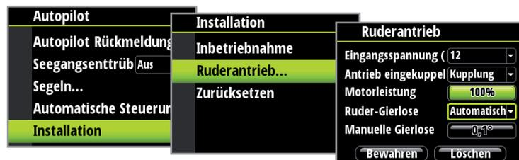
Wenn die automatische Einstellung aufgrund einer großen Trägheit des Steuerrads nicht korrekt funktioniert, kann sie manuell angepasst werden.
