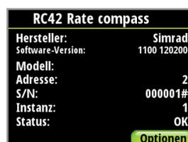
Einige Geräte, zum Beispiel der RC42 Rate compass, speichern ihre Konfigurations-, Kalibrierungs- und Offsetdaten im eigenen Speicher, nicht im Display-Speicher. Für ein solches Gerät können Sie Dateninformationen prüfen und konfigurieren und es kalibrieren, indem Sie „Optionen“ wählen.
