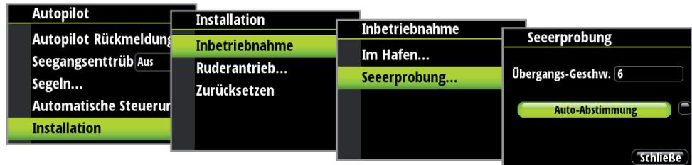
Während des automatischen Einstellungsprozesses wird zudem die in der Hafeneinstellung vorgenommene Nullausrichtung des Ruders verifiziert/angepasst. Die Auto-Abstimmung ist für die Funktionsfähigkeit des Autopiloten nicht erforderlich, da sie auf Steuerungsparameter voreingestellt ist, mit denen die meisten Boote von ca. 9 bis 12 Metern Länge gesteuert werden können.
