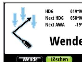
Durch Drücken von „ENTER“ auf dem Display oder „AUTO“ auf dem Pilot Controller wird die Wende-/Halsenfunktion aktiviert, und das Boot dreht sich auf den neuen Windwinkel.
